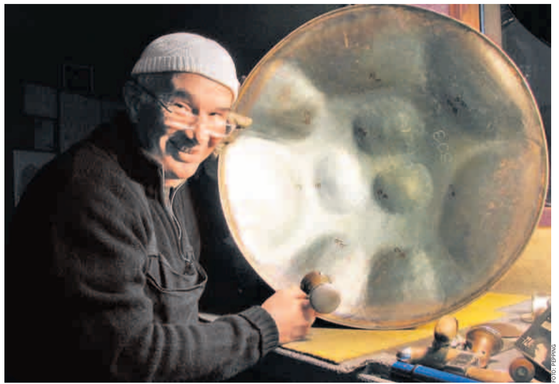
Schulz bei der Feinabstimmung einer Steeldrum: Je stärker der Stahl an einer Stelle gedehnt ist, desto höher der Ton
